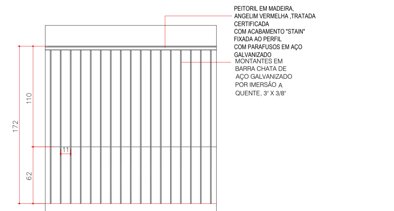
GUARDA-CORPO - GC GUARDA-CORPO EM AÇO GALVANIZADO POR IMERSÃO A QUENTE VISTA FRONTAL - ESCALA 1:25
